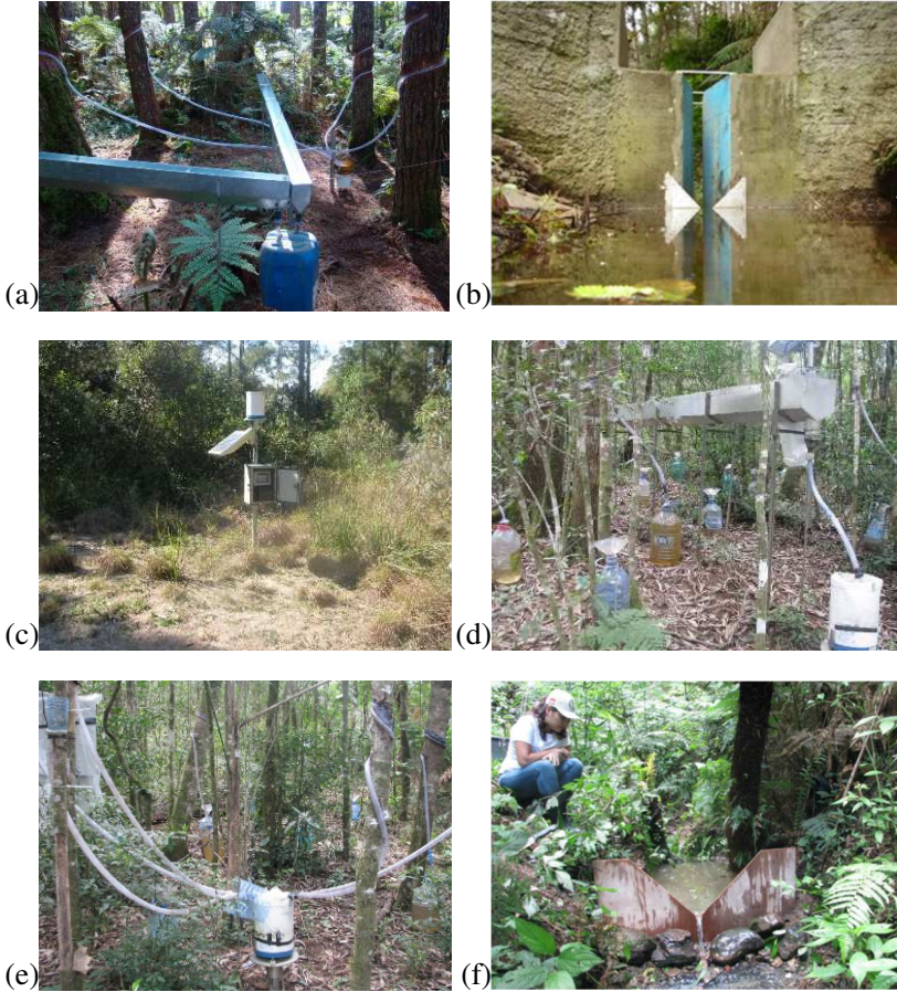
Figura 12. Pontos de monitoramento. (a) Medição de chuva interna e escoamento pelos troncos na bacia do rio Saci (CHAFFE, 2009). (b) Medição de vazão na bacia do rio Saci (CHAFFE, 2009). Medição de (c) chuva total, (d) chuva interna, e (e) escoamento pelos troncos na bacia do rio Araponga (SÁ, 2015). (f) Medição de vazão na bacia do rio Araponga (MOTA, 2017).
