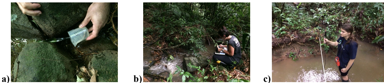
Figura 2 – Fotos das medições de vazão utilizando os métodos : a) volumétrico; b) químico; e c) molinete
