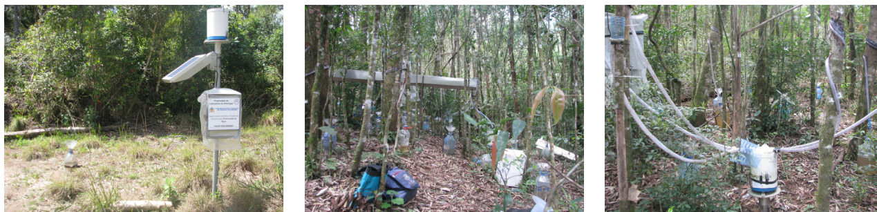
Figura 2– Fotografia dos pontos de monitoramento: (a) pluviógrafo de medição da chuva externa ( P ); (b) calha para coleta da chuva interna ( Tf ); e (c) mangueiras da coleta do escoamento pelos troncos ( Sf ).
